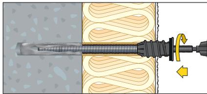
6. Sechskantbit (im Set enthalten) in den M12 Gewindestift stecken und den ResiTHERM® 16 bzw. 12 mittels Akkuschrauber einschrauben, bis die Dichtung press am Putz anliegt.
