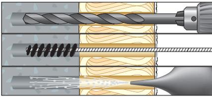
1. Bohrloch erstellen: Bohrlochtiefe + Dämmstoffdicke
