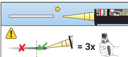
6. Die Mischdüsenverlängerung MDV auf die Mischdüse MD stecken. Injektionsmörtel auspressen bis der Mörtel eine einheitliche graue Mischfarbe hat - den Vorlauf der ersten mind. 3 Hübe verwerfen.
