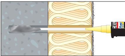
5. Das Bohrloch zu mind. 2/3 mit Verbundmörtel füllen (von vorne beginnen). Für Anzahl Hübe siehe Montageanleitung unter [www.celofixings.de](http://www.celofixings.de).
