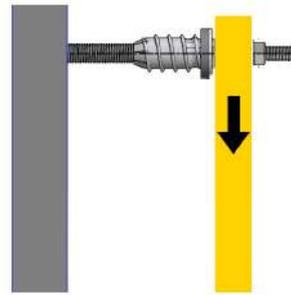
**Maximale Querlasten V <sup>1)</sup> bei max. 3 bzw. 5 mm Verschiebung pro ResiTHERM® bei freibeweglichem äußeren Ende des ResiTHERM® 16 & 12 bei 24°C/40°C <sup>2)</sup>**
