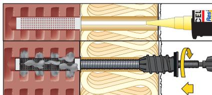
7. Die Siebhülse komplett mit Verbundmörtel füllen. Für Anzahl Hübe siehe Montageanleitung unter [www.celofixings.de](http://www.celofixings.de)
