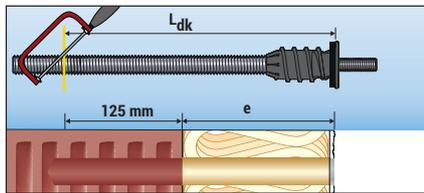
3. ResiTHERM® 16 bzw. 12 ablängen: Richtige Länge  $L_{dk}$ : Verankerungstiefe in Siebhülse (125 mm) + Dämmstoffdicke e (inkl. Putz). Nach Ermittlung der richtigen Länge die Gewindestange mit einer Metallsäge o.ä. ablängen.
