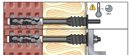
9. Aushärtezeit des Injektionssystems beachten, siehe Kartuschenetikett des Injektionsmörtel ResiFIX.
