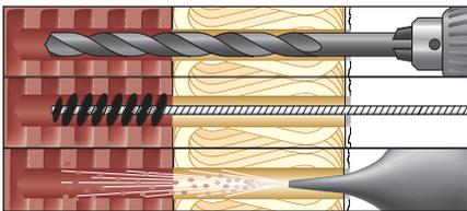
1. Bohrloch erstellen: Bohrdurchmesser = 20 mm. Bohrlochtiefe  $\geq 140 \text{ mm} + \text{Dämmstoffdicke}$  (inkl. Putz). Bohrverfahren der Zulassung/Bewertung des Injektionsmörtel ResiFIX beachten.
