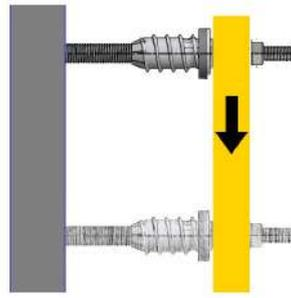
**Maximale Querlasten V <sup>1)</sup> bei max. 3 bzw. 5 mm Verschiebung pro ResiTHERM<sup>®</sup> bei verdrehbehinderter Lagerung des freien äußeren Endes des ResiTHERM<sup>®</sup> 16 & 12 bei 24°C/40°C <sup>2)</sup>**
