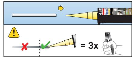
4. Die Mischdüsenverlängerung MDV auf die Mischdüse MD stecken. Injektionsmörtel auspressen bis der Mörtel eine einheitliche graue Mischfarbe hat - den Vorlauf der ersten mind. 3 Hübe verwerfen.
